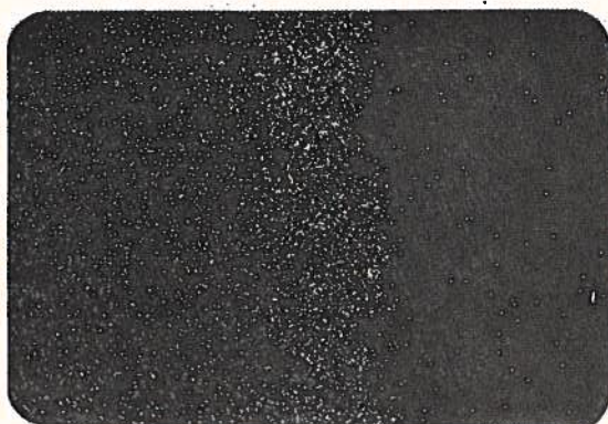
Röntgenbeeld van \text{Cr} over de oxydelaag van \text{Cr}_2\text{O}_3 .
