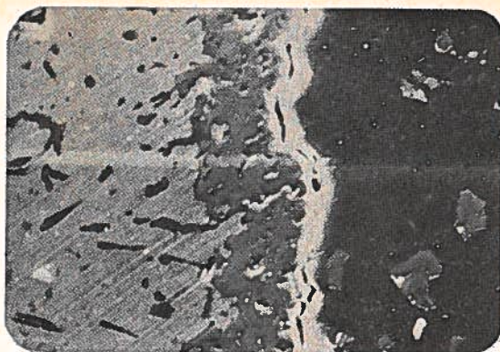
Secundaire elektronenbeeld van de oxydelaag van \text{Cr}_2\text{O}_3 .
